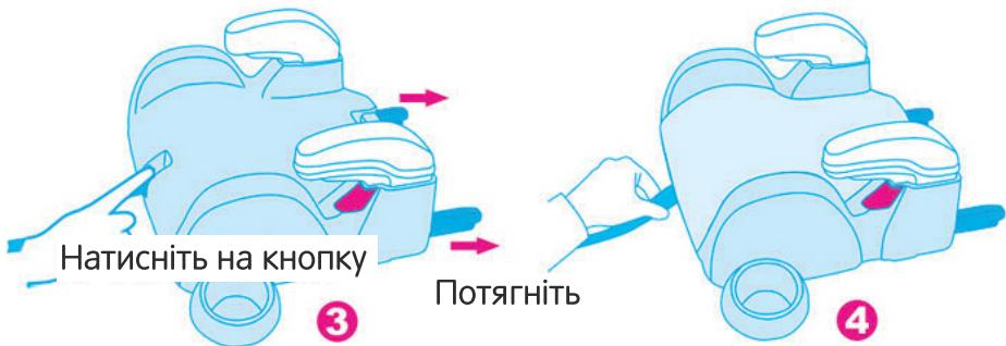
4. Зсуньте плечовий ремінь автомобіля на затискач (мал. 3) та витягніть ремінь вниз, щоб затягнути на плечі дитини (мал.4). Стегновий ремінь безпеки повинен проходити під підлокітником та розташовуватись на стегнах на низькому рівні. Ремінь не повинен бути перекрученій.
