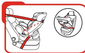
2. Витягніть автомобільний ремінь та протягніть в червоні роз'єми на кріслі. Плечовий ремінь просмикніть крізь роз'єм на задній частині крісла на підголовнику.
