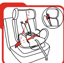
2. Потягніть поясний та діагональний ремінь безпеки автомобіля до повного висунення, протягніть діагональну частину реміння безпеки автомобіля крізь роз'єм на задній частині крісла на підголівнику.
