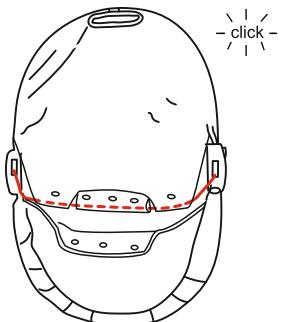
4. Зафіксуйте сидіння за допомогою кнопок.
